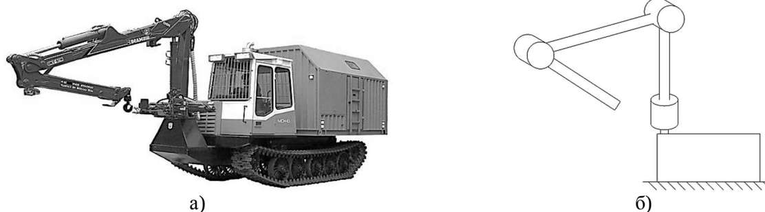
Рис. 1. Кран-манипулятор на гусеничном шасси и его кинематическая схема: а – кран-манипулятор; б – кинематическая схема
